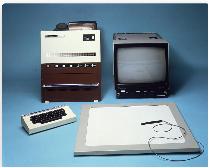
El Quantel Paintbox DPB 7001: la unidad central con su disco, el monitor, el teclado — y la tableta con lápiz, la herramienta para todo.
