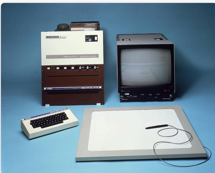
Le Quantel Paintbox DPB 7001 : l'unité centrale et son disque, le moniteur, le clavier — et la tablette au stylet, l'outil de tout.
