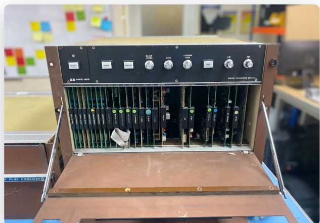
El chasis abierto: la fila de tarjetas «FRAME STORE», las memorias de imagen que lo cambiaron todo.
