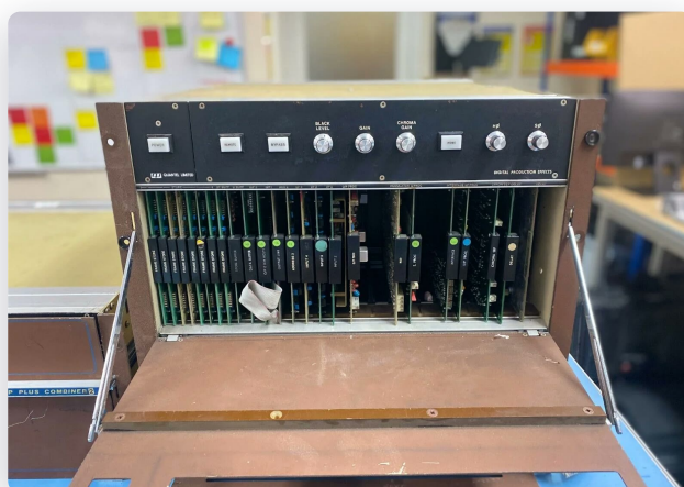
Le châssis ouvert : la rangée de cartes « FRAME STORE », les mémoires d'image qui ont tout changé.
